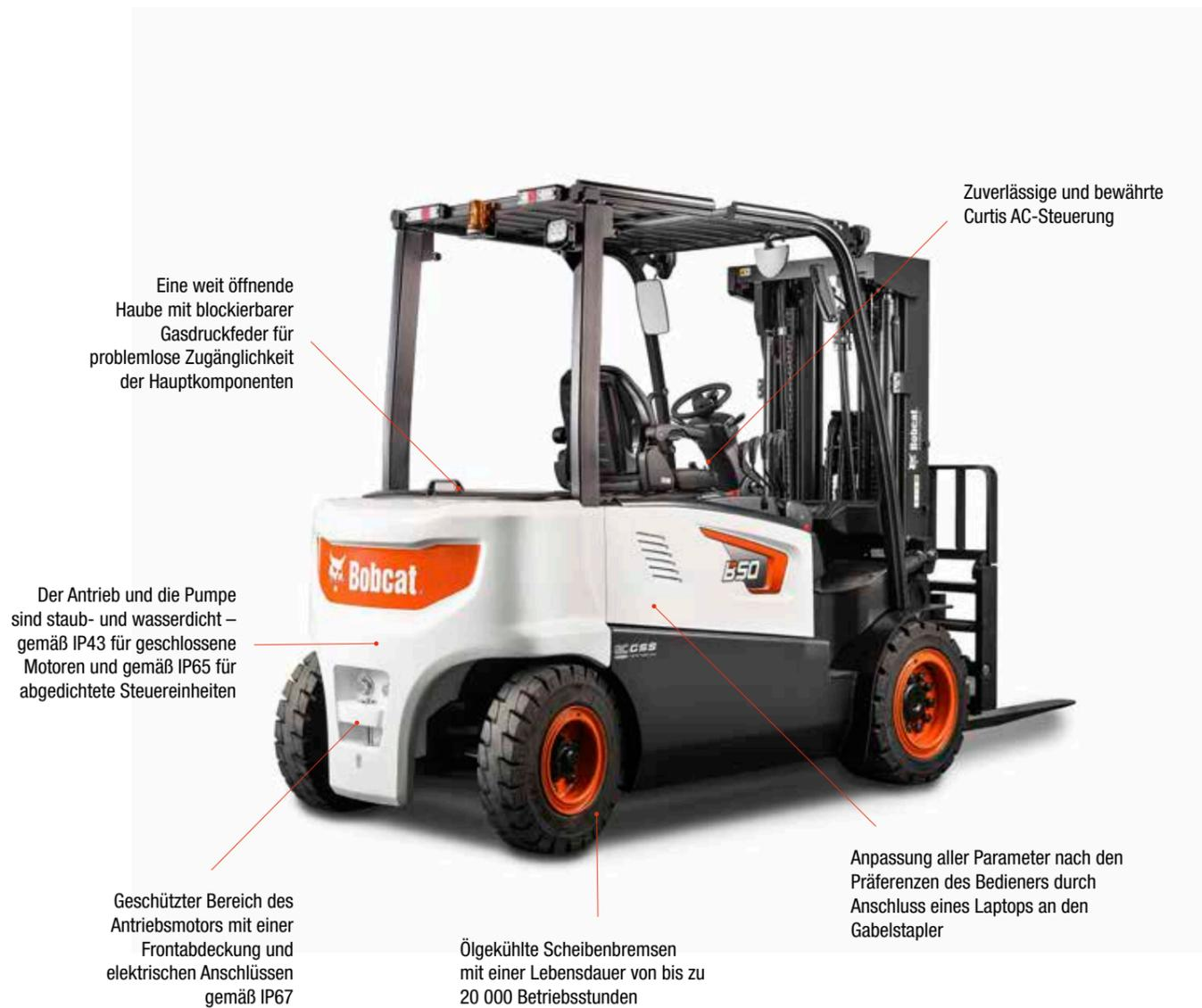
Eine weit öffnende Haube mit blockierbarer Gasdruckfeder für problemlose Zugänglichkeit der Hauptkomponenten
