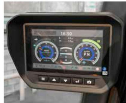
Das 7-Zoll-Farbdisplay ist strategisch auf Augenhöhe positioniert, um den Komfort zu erhöhen. Es bietet eine hervorragende Sicht im Außenbereich und informiert den Fahrer umfassend über den Maschinenstatus.
