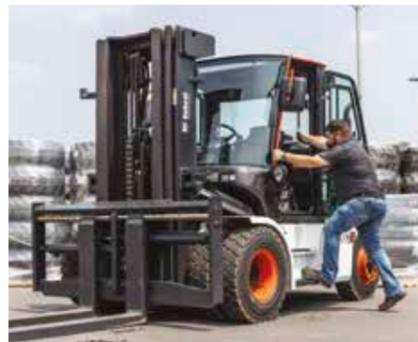
Dieser Gabelstapler verfügt über eine niedrige Stufenhöhe, die einen einfachen und sicheren Ein- und Ausstieg ermöglicht – ergänzt durch einen Haltegriff und eine rutschfeste Trittstufe.
