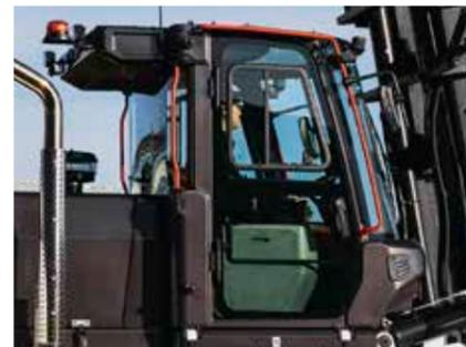
Die zwei großen Luftfilter der druckbeaufschlagten Kabine halten Staub effektiv fern und erhöhen den Fahrerkomfort. Außerdem genießen Sie minimalen Lärm am Ohr des Fahrers und reduzierte Vibrationen.
