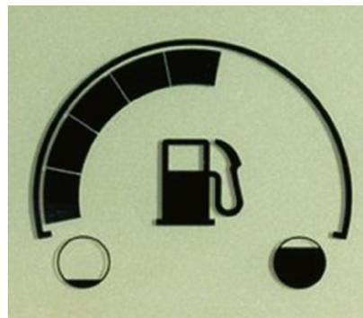
**Elektronische Kraftstoffanzeige:** Dank der gut ablesbaren Kraftstoffanzeige wissen Sie immer, wann Sie das nächste mal in die Box müssen. (Nicht beim X350R. Dieser hat eine Kraftstoff-Reserveanzeige, die bei einem geringen Kraftstoffvorrat zu blinken beginnt.)
