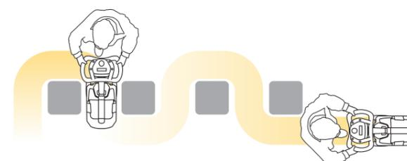
Die Bürsteneinheit verstellt sich seitlich zum Maschinengestell und ermöglicht dadurch die perfekte Reinigung
