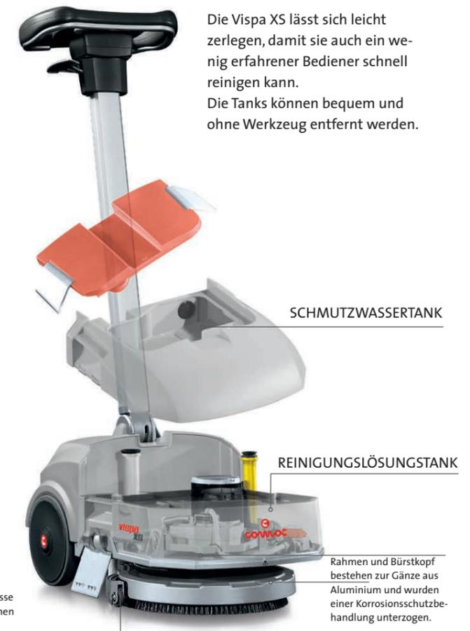
Die Vispa XS lässt sich leicht zerlegen, damit sie auch ein wenig erfahrener Bediener schnell reinigen kann. Die Tanks können bequem und ohne Werkzeug entfernt werden.
