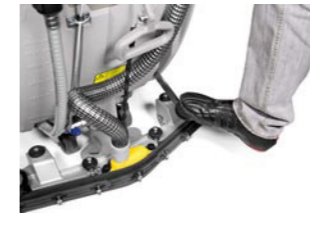
Bequemes Anheben und Absenken des Bürstkopfes mit Hilfe des Fußpedals.
