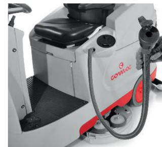
Über das Schnellbefüllsystem kann die Maschine direkt an den Wasserhahn angeschlossen werden.
