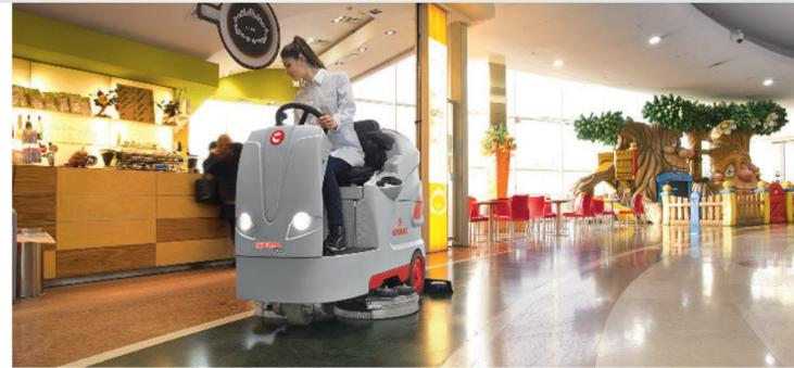
Alle Bestandteile der Maschine, die täglich gereinigt bzw. gewartet werden müssen, sind einfach an der gelben Farbgebung zu identifizieren. Dies erspart Zeit und gibt Sicherheit im täglichen Umgang.
