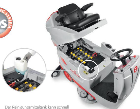
Der Reinigungsmitteltank kann schnell ausgetauscht oder wieder aufgefüllt werden.
