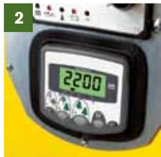
**2- VARIO-STRESS-SYSTEM** Automatischer Überlastschutz. Einstellbare Abschaltbereiche je nach Material.
