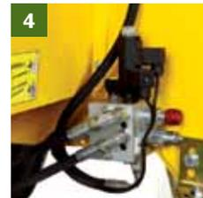
**4- HYDRAULISCHER ÖLMENGENTEILER.**
