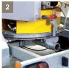
2- KOMPLETTER HÄCKSLER UM 360° SCHWENKBAR – dadurch ist der Einfülltrichter immer dort wo Sie ihn brauchen.
