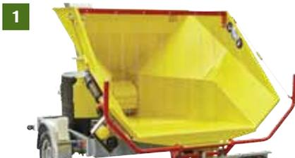
**1- BREITER UND LEICHT ZUGÄNGLICHER EINFÜLLTRICHTER** mit transparentem Schutzvorhang.
