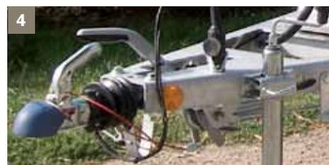
**4- FAHRGESTELL MIT BREMSE** zulässiges Gesamtgewicht unter 750 kg.
