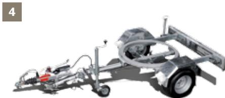
4- GEBREMSTES FAHRGESTELL, vollverzinkt mit höhenverstellbarem Zugdeichsel.
