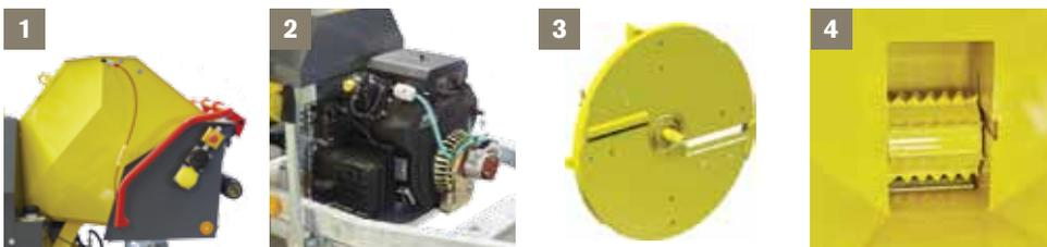
1- EINFÜLLTRICHTER KLAPPBAR für den Transport.
