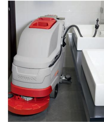
Einfaches Befüllen des Frischwassertanks mit Hilfe des herausziehbaren Schlauchs. Maschine kann somit überall aufgetankt werden.
