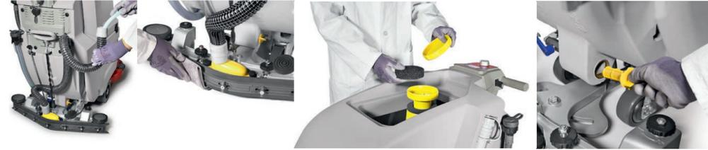
Für eine perfekte Absaugung: Reinigung des Saugschlauches und der Sauggummis nach jedem Einsatz.
