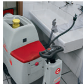
Schnellbefüllsystem des Frischwassertanks
